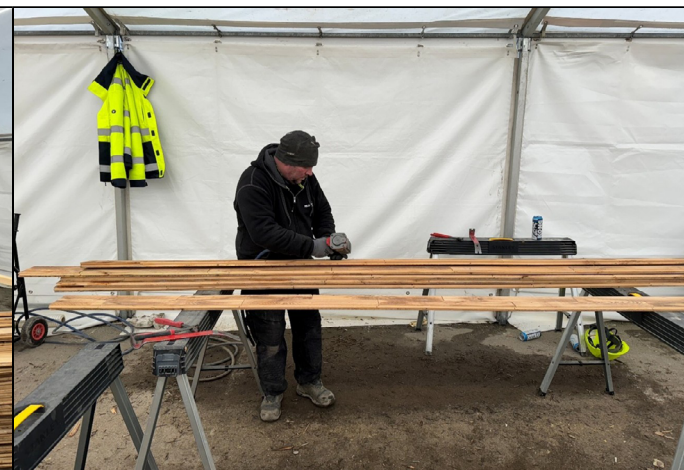
8. Sømmene skydes ud med trykluft og brættet tjekkes med metaldetektor
